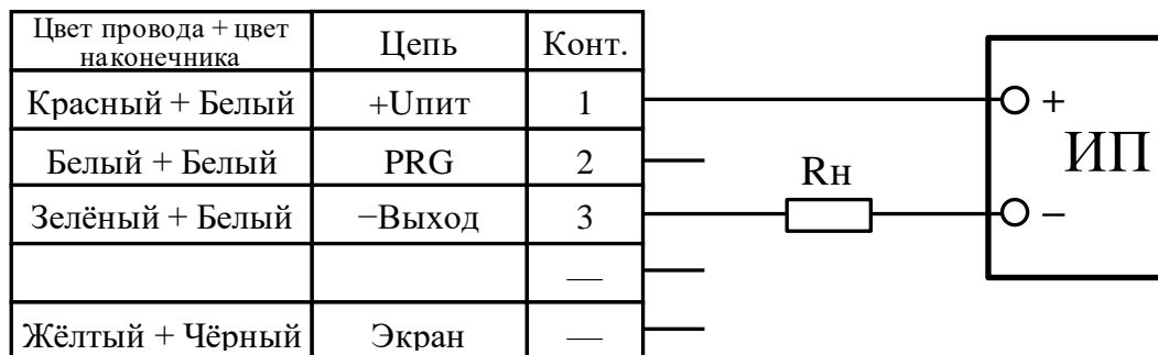
Рисунок В.3 — Соответствие цепей выводам разъёма преобразователей с кодами исполнений 14 и 15 по таблице А.10
